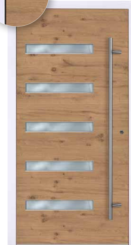
TL6 Rahmen: RAL 9016 Flügel: Eiche, astig und geölt Griff: TR 160/45 und AJM Rundrosette Glas: Satinato mit einem Ug-Wert von bis zu 0,5 W/m2K
